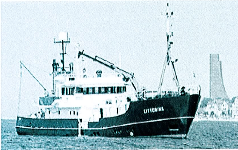
Mit dem Kran werden Bohrkern gezogen und Ausrüstung an und von Bord gehievt
